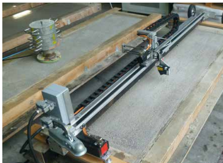
Bild 4: Bestimmung des texturinduzierten Strömungswiderstands (links) und Messung der Textur mit dem Laserprofilometer (rechts)
