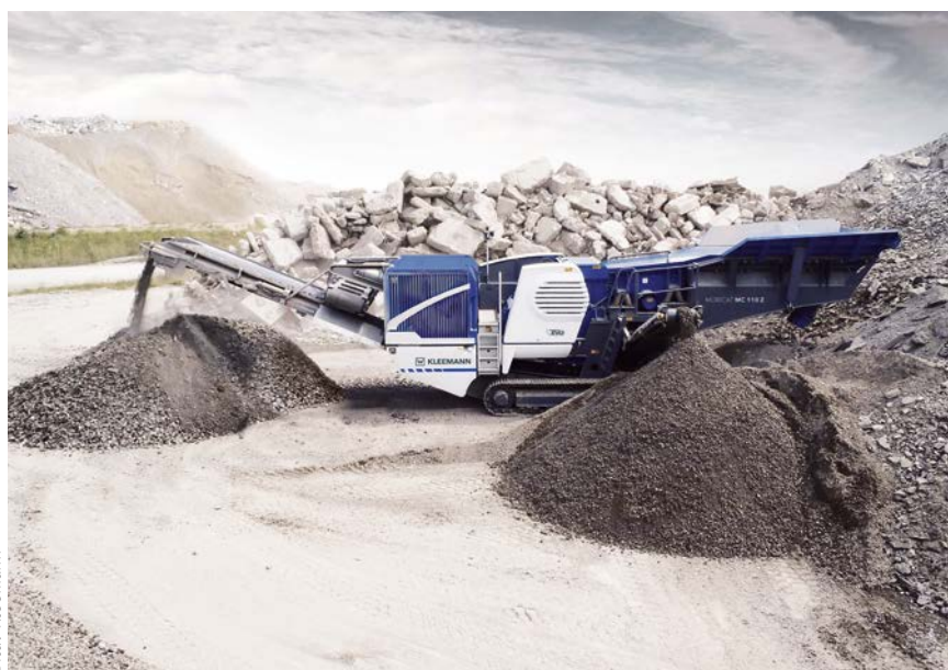
Brecheranlage für das Recycling von Betondecken
