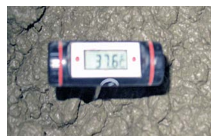
Bild 4: Frischbetontemperatur von 37,6 °C
