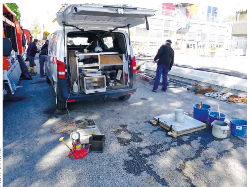
Bild 8: Frischbetonkontrollen mit Laborwagen auf der Baustelle
