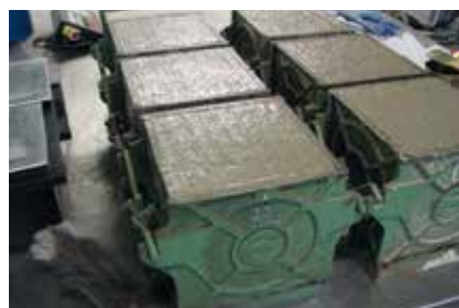
Bild 3: 20er Probewürfel mit Besenstrich
