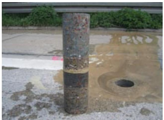
**Bild 8: Bohrkern**
