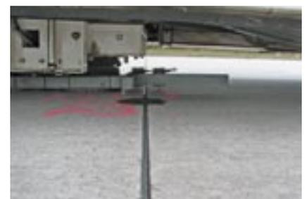
**Bild 3:** Tragfähigkeitsmessung mit Hilfe eines Falling Weight Deflectometers an einer Querscheifuge
