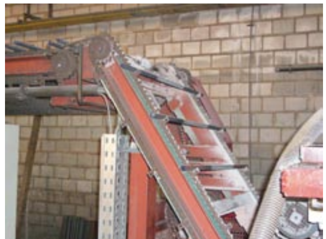
Bild 4: Aufbringen der Kunststoffbeschichtung für Anker
