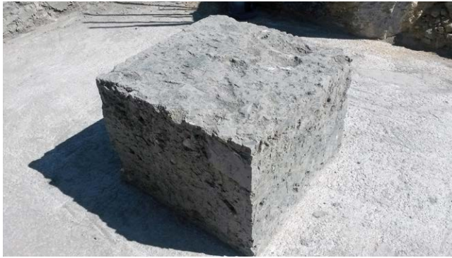
Bild 4: Herauspräparierter Prüfkörper mit den Maßen 0,8 m x 0,8 m x 0,6 m, D_{pr} \geq 95 \%
