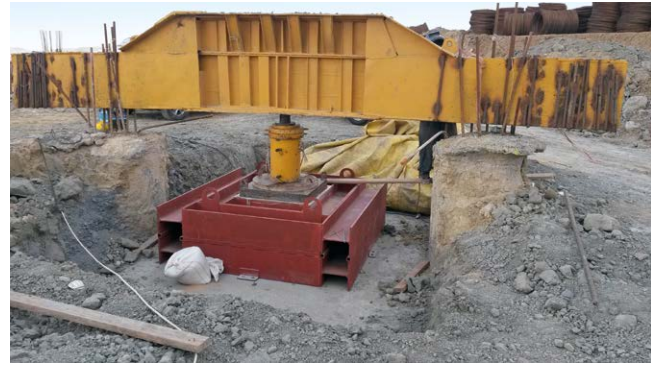
Bild 5: Großmaßstäblicher Ödometerversuch – Versuchsaufbau
