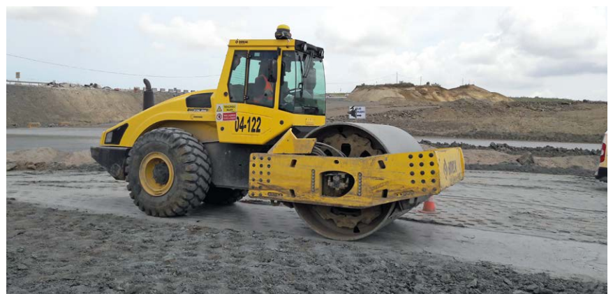
Bild 6: 26t-Walzenzug mit GPS und FDKV-Messsystem
