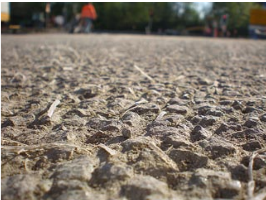
Bild 6: Waschbetonoberfläche mit PPE-Fasern
