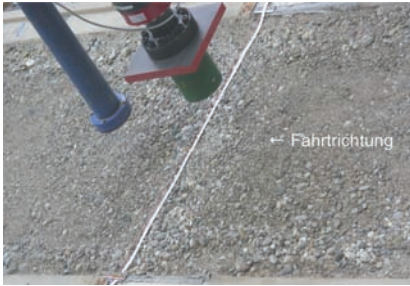
Bild 13: Freigelegte Oberfläche der modifizierten Kiestragschicht Km nach dem Dauerschwingversuch mit Wasserzugabe; simulierte Fahrtrichtung von rechts nach links; das weiße Maßband markiert den Verlauf der – zunächst als verdübelt, dann in der Schlussphase als unverdübelt simulierten – Fuge
