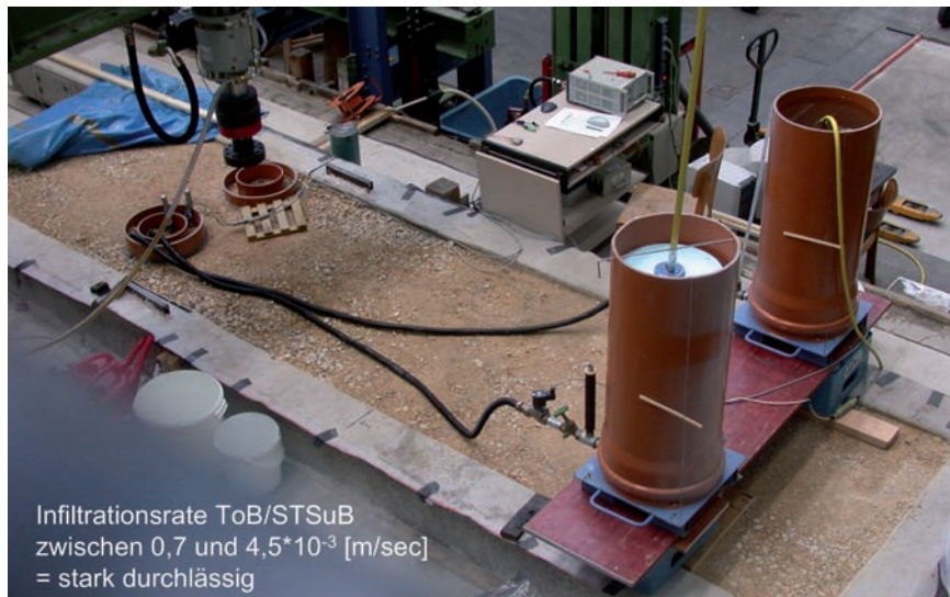
Bild 15: Messen der Wasserdurchlässigkeit der ToB/STSuB im Großprüfstand mit dem Doppelring-Infiltrometer
