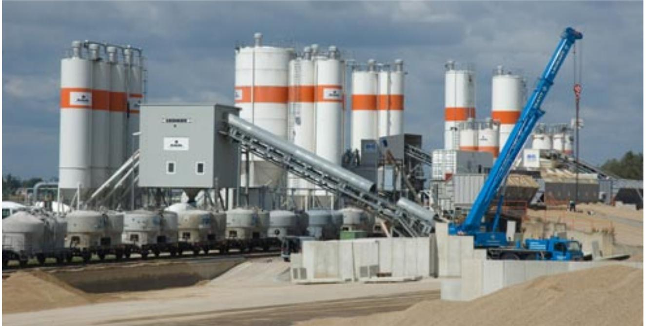
**Mischanlagenbatterie mit einem davor löschenden Zementzug (1200 t). Löschleistung der Umschlagsanlage max. 150 t/h**
