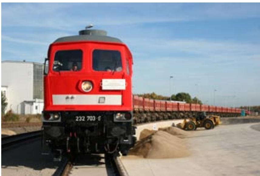
**Ankunft eines Gesteinskörnungszuges (1800 t) und anschließender Umschlag aus den Kippkanten auf die Vorratshalden**
