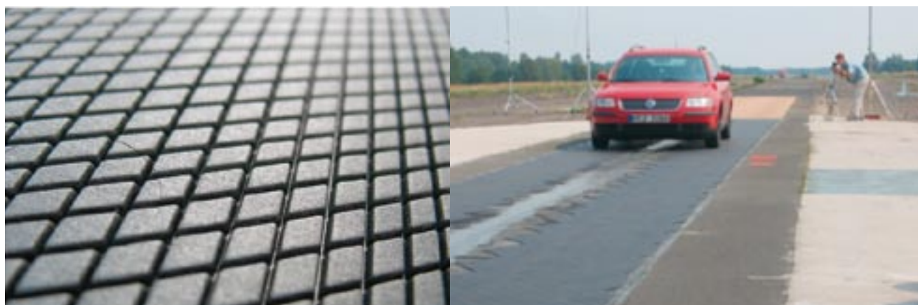
Bild 7: Erste Realisierung einer mathematisch optimierten Textur. Links: Oberfläche des Fertigteilelements; rechts: befahrbare Deckschicht aus Fertigteilelementen.
