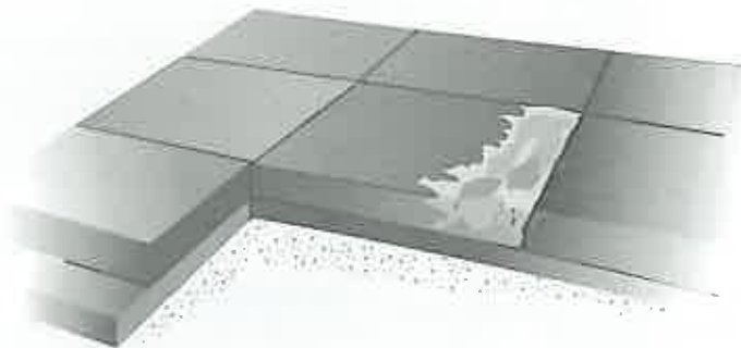
Bild 2: Abplatzen des oberen Betons
