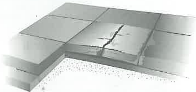
Bild 3: Ausknicken von Platten bzw. Plattenteilen
