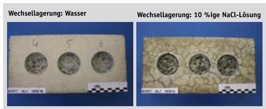
**Bild 10: Haftzugprüfung der geschalten Unterseite nach 6 Monaten Prüfung mit dem 60 °C- Betonversuch mit unterschiedlicher Wechselagerung: Wechselagerung mit zwei Tagen Wasserlagerung (links) und Wechselagerung mit Alkalizufuhr von außen mit zwei Tagen Lagerung in 10 %iger NaCl-Lösung (rechts) bei der Variante mit Grauwackesplitt/Entaktivierer**
