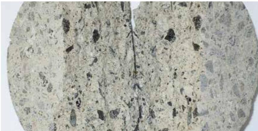
Bild 1: Bruchbild einer Spaltzugprobe
