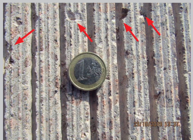
Bild 11: „Porigere“ Oberfläche mit unsteten Flankenanten infolge von Kornausbrüchen
