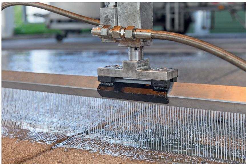
Bild 2: Druckloser Auftrag des Reaktionsharzes im Gießverfahren
