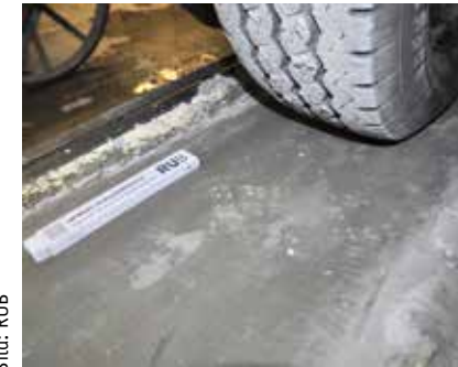
Bild 3: Überrollversuch zur Simulation frühzeitiger Beanspruchungen
