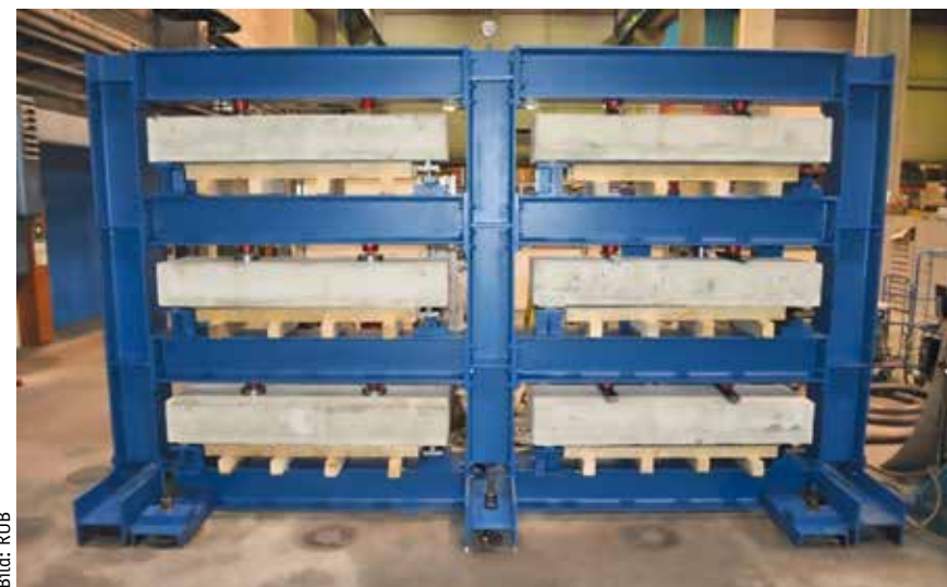
Bild 1: Mehrfachprüfstand für zyklische Untersuchungen an Großbalken
