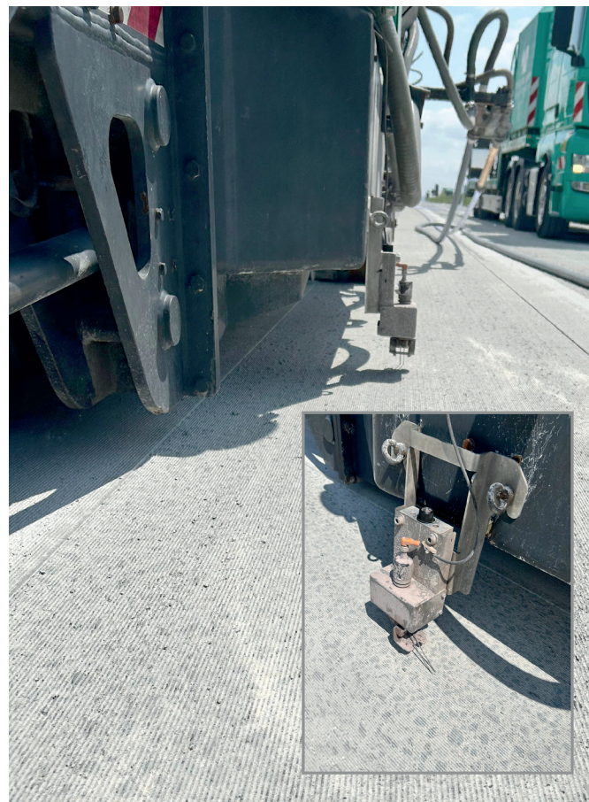
Bild 3 Anbausatz zur Nachrüstung von Grindingmaschinen
