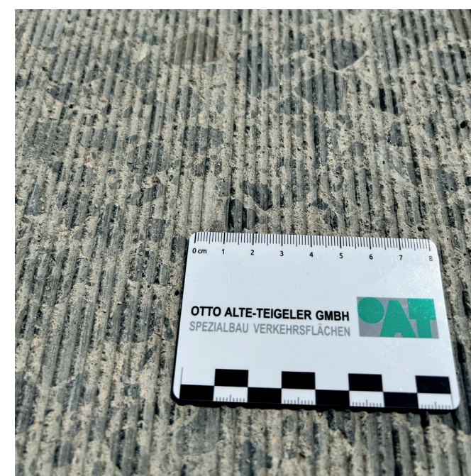
Bild 1 Minimale Überlappung von Grindingbahnen (Bilder: OAT)
